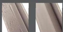
アルミアングル 樹脂アングル アルミアングル部に大量の水滴が見られるのに対し、樹脂アングル部にはほとんどみられません。
